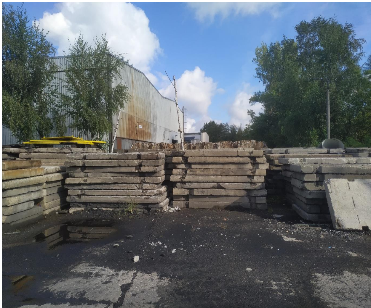
Składowanie płyt drogowych
